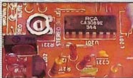
Der UKW-Tuner hat Feldeffekttransistoren (MOSFET's).
