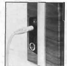
Tandberg Portabel Radio har anslutningskontakter för bandspelare/skivspelare, batterieliminatör, hörtelefon, extra högtalare och utvändigt antenn.
