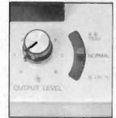
Separata avspelningskontroller för båda kanalerna. Omkopplare med 3 lägen – S ON S (»Sound-on-Sound»), NORMAL, AB-TEST.
