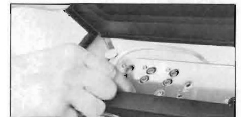
Modell 6000X är försedd med lock som döljer alla anslutningar när bandspelaren används i vertikalt läge.
