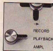
Funksjonsvenderen bestemmer båndopptakerens 3 hovedfunksjoner – innspilling, avspilling og forsterker.
