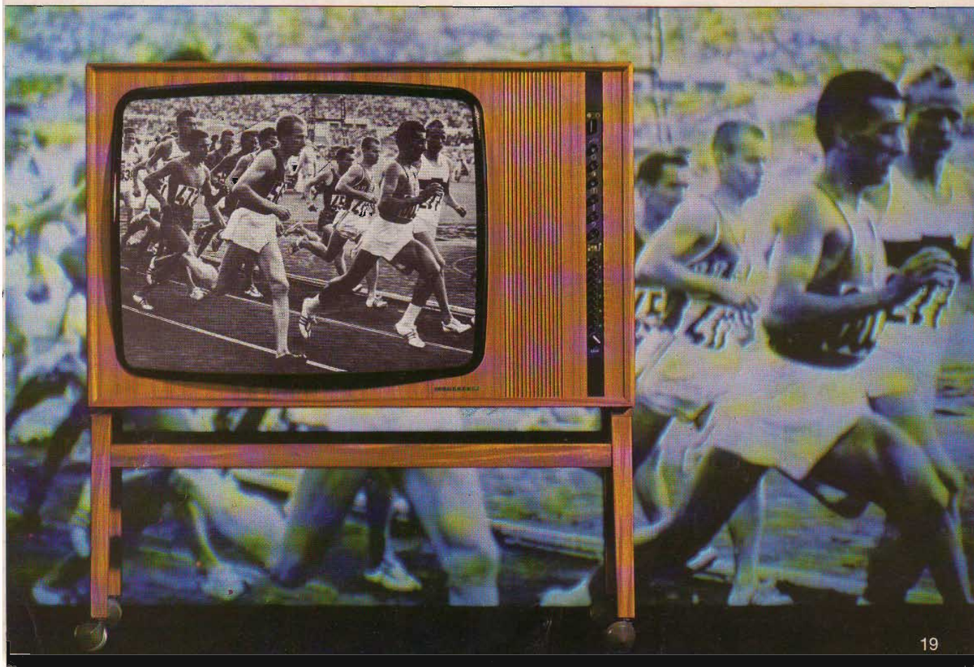
Betjeningspanelet er plassert til høyre på apparatets front, ved siden av høytaleren. Trykk inn nettbyteren — og lyden kommer med én gang! Den transistoriserte kanalvelgeren av Tandbergs egen konstruksjon er trykk-knappbetjent og derfor enkel i bruk.
