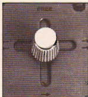
En-spak betjening av hurtig frem- og tilbakespuling og normal fremdrift for opptak og avspilling. Enkel og sikker.
