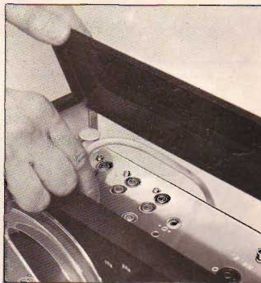
Modell 6000X Stereo kan anvendes i vertikal stilling. Under dekselet er tilkoplingskontakter for radio og platespiller. Videre er det pick-up vender for valg mellom magnetisk og keramisk pick-up, senterkanaluttak, linjeinnganger og linjeutganger, spenningsuttak for Tandberg FM-multiplexfilter og kontakt for fjernkontroll av båndopptakeren.
