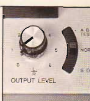
Det er separate avspillingskontroller for begge kanaler. "Sound-on-Sound" — vender med 3 stillinger.
