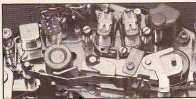
Modell 11 har tre lydholder for slukking, innspilling og avspilling samt tachometerhode for elektronisk hastighetskontroll. Modell 11-1P har i tillegg et hode for pilot-tone.
