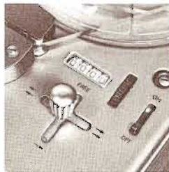
En-spaksbetjäning av snabbspolning fram och tillbaka samt normal framdrift. Enkelt, lättskött, driftsäkert.
