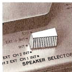
Högtalaromkopplare med 5 lägen. Programmet kan dirigeras över såväl inbyggda som extra högtalare.
