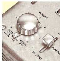
Funktionsväljaren har tre lägen: inspelning, avspelning och förstärkarläge.
