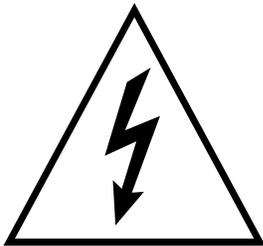
Dieses Symbol verweist auf nicht-isolierte Stromspannungen im Geräte-Innern, welche zu einem elektrischen Schlag führen könnten.
